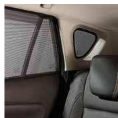
2.7 Солнцезащитные экраны. Комплект из 5 шт. для заднего и задних боковых стекол. 990E0-61M20-000
