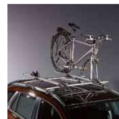
4.8 Крепление для велосипеда «Giro Speed». Для перевозки велосипеда с демонтированным передним колесом (только в сочетании с багажником 990E0-61M18-000). 990E0-59J21-000
