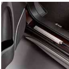
3.2 Накладки на пороги. Комплект из 4 шт. Серебристые с чёрным и логотипом Suzuki. 990E0-61M30-000 Алюминиевые, с логотипом Suzuki. 990E0-61M60-000 (без рис.)
