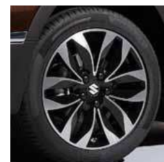
1.6 Легкосплавный диск 6,5Jx17". Для шин 205/50 R17, включая колпак центрального отверстия с логотипом Suzuki, одобрен сертификатом ECE-R 124. Серебристый. 990E0-61M75-000 Чёрный матовый. 990E0-61M76-000 Чёрный полированный. 990E0-61M78-000
